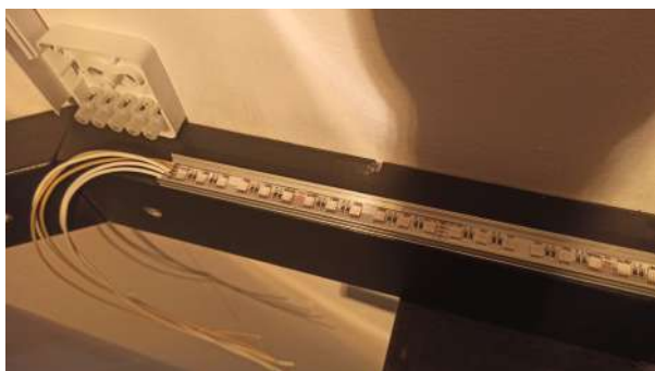
Figur 3: Gatans LED-listor i sin aluminiumprofil, och på den högra bilden syns även de 3D-printade fästena.
